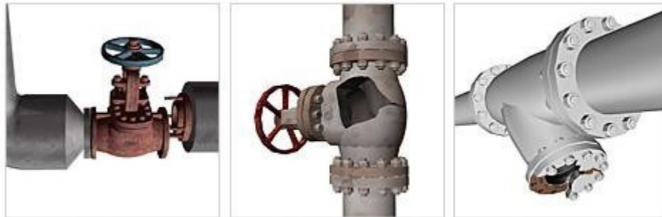
Figure 4.3 : Exemple de quelques dommages causés par un coup de bélier
