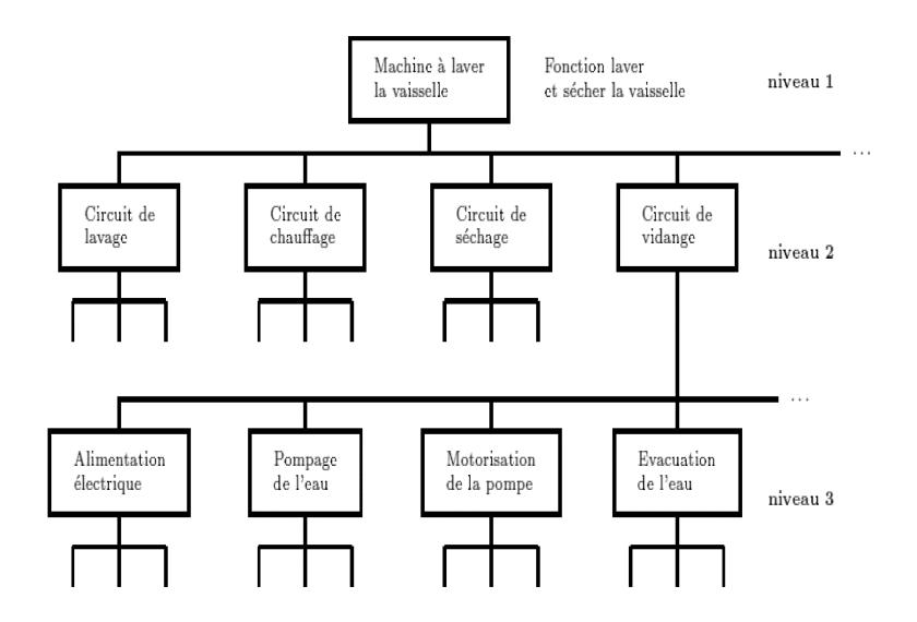
Figure 3 – Description fonctionnelle d'une machine à laver la vaisselle
