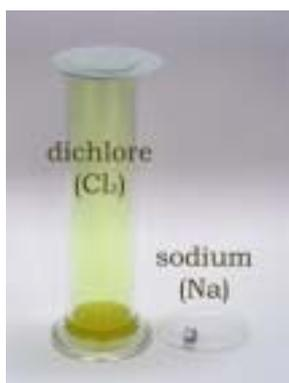
Dans un tube à essai à trou latéral, un petit morceau de sodium est chauffé dans la flamme du brûleur Bunsen. Ensuite, le tube contenant le sodium enflammé est introduit dans un récipient rempli de dichlore.
