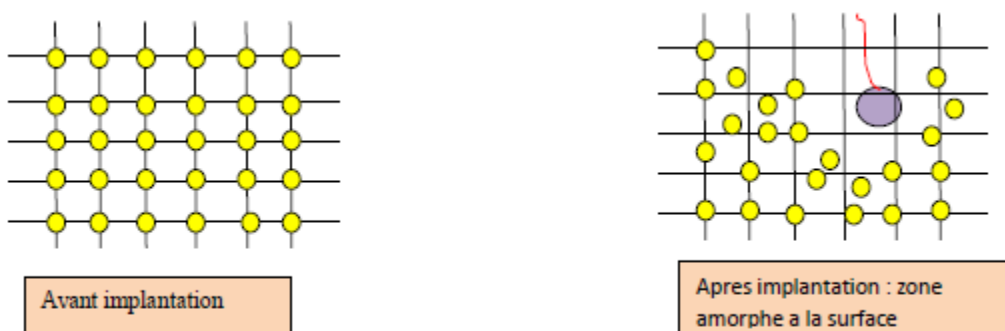
Figure IV.3: Création d'une zone amorphe à la surface du semi-conducteur par le bombardement ionique.
